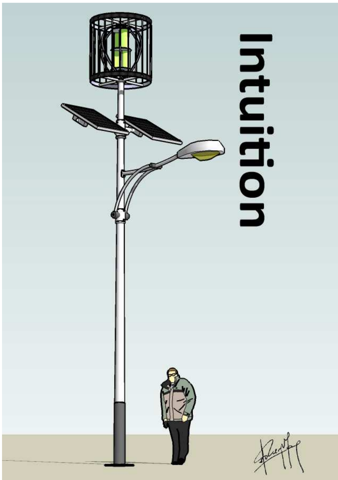
Rys. 5, Projekt kosza osłaniającego turbinę o osi pionowej opracowany na potrzeby inwestycji w Gminie Zarszyn, woj. Podkarpackie (wersja 2)
